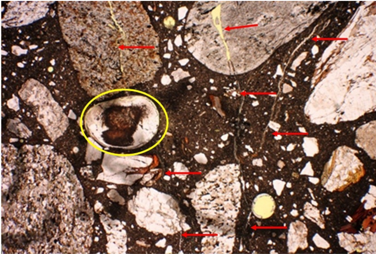
Kuva 7. Näyte 6. Alkalireaktiossa syntyvä halkeilu leikkaa kiviainesrakeita ja sementtikiveä (punaiset nuolet). Reaktiossa syntyvä alkalipiigeeli saostuu huokosten seinämiin (keltaisella merkitty huokonen täynnä geeliä) ja halkeamiin aiheuttaen betoniin paisuntaa ja halkeilun kasvua. Kuvan lyhyt sivu vastaa noin 7 mm näytteessä.
